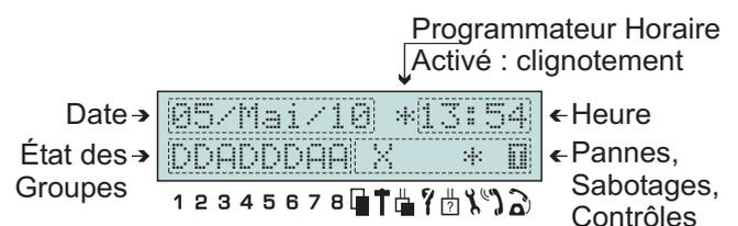
**Figure 3** L'afficheur des claviers LCD en Modalité "Affichage état Groupes".
